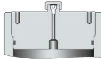
Beispiel 1: Füllventil für Membranspeicher M 28 x 1,5 example 1: filling valve for diaphragm accumulator M 28 x 1,5
